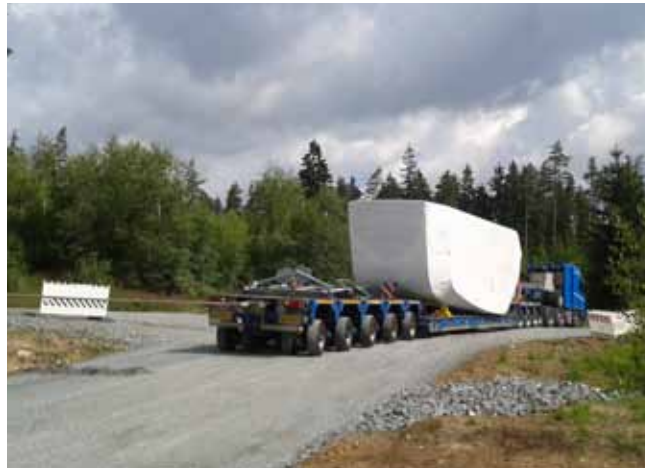
01.07.2014: Die Anlieferung der Großkomponenten beginnt. Hier: Transport des Maschinenhauses
